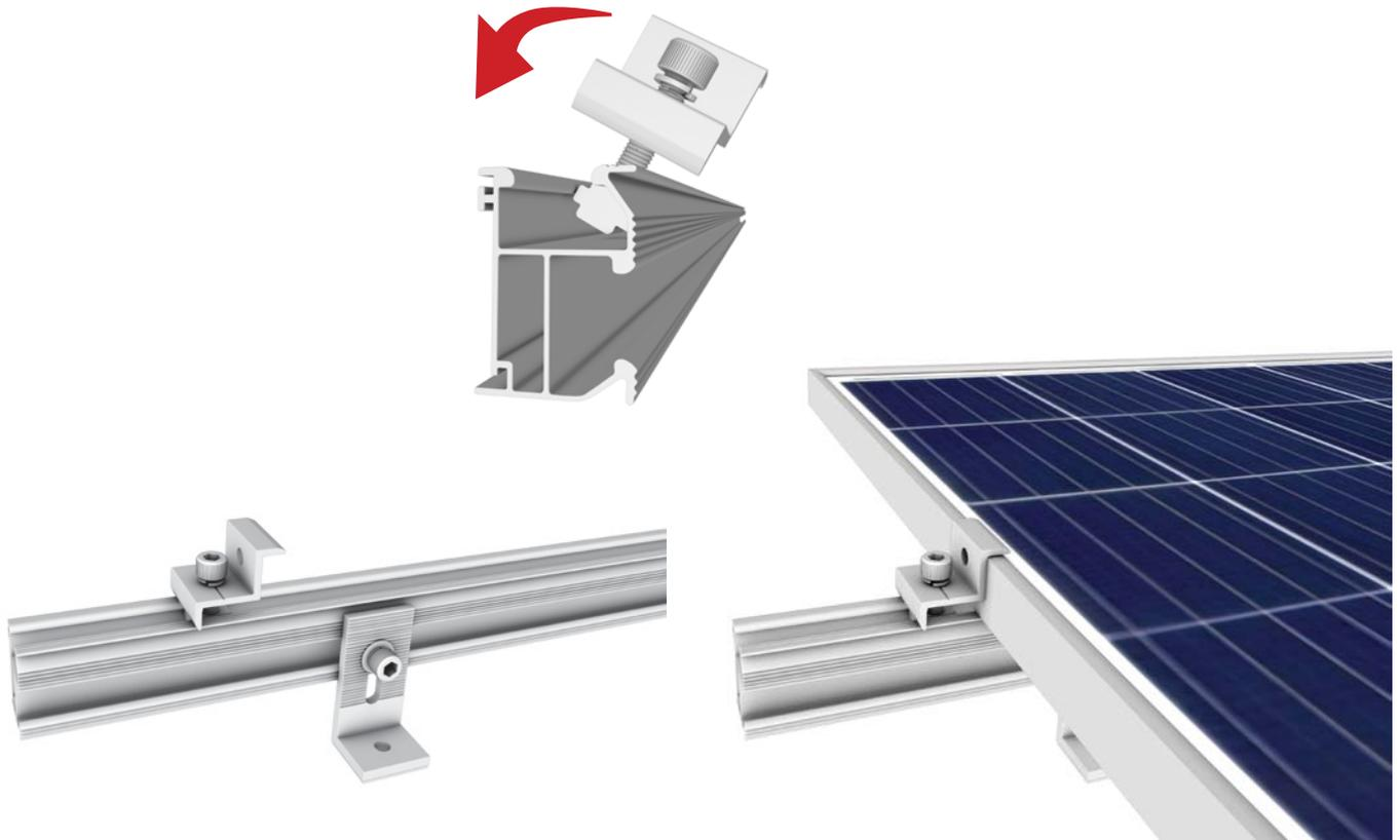
Continuamos con el siguiente panel pero esta vez utiliza los **Inter Clamp**. Repite la operación hasta que llegues al último panel de la fila, terminaremos otra vez con los **End Clamp**, como empezamos a sujetar el primero.
