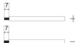
**Conexión de cable del módulo fotovoltaico**
