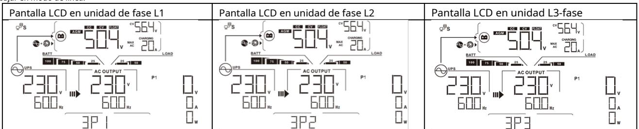
Paso 5: Si no hay más alarma de falla, el sistema para soportar equipos trifásicos está completamente instalado.
