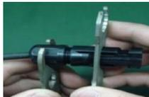
**Paso 4:** Compruebe la polaridad correcta del cable de conexión de los módulos fotovoltaicos y los conectores de entrada fotovoltaica. Luego, conecte el polo positivo (+) del cable de conexión al polo positivo (+) del conector de entrada fotovoltaica. Conecte el polo negativo (-) de cable de conexión al polo negativo (-) del conector de entrada fotovoltaica.
