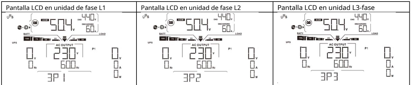
Paso 4: Encienda todos los disyuntores de CA de los cables de línea en la entrada de CA. Si se detecta una conexión de CA y hay tres fases emparejados con la configuración de la unidad, funcionarán normalmente. De lo contrario, el icono de CA parpadearán y no lo harán trabajar en modo de línea.
