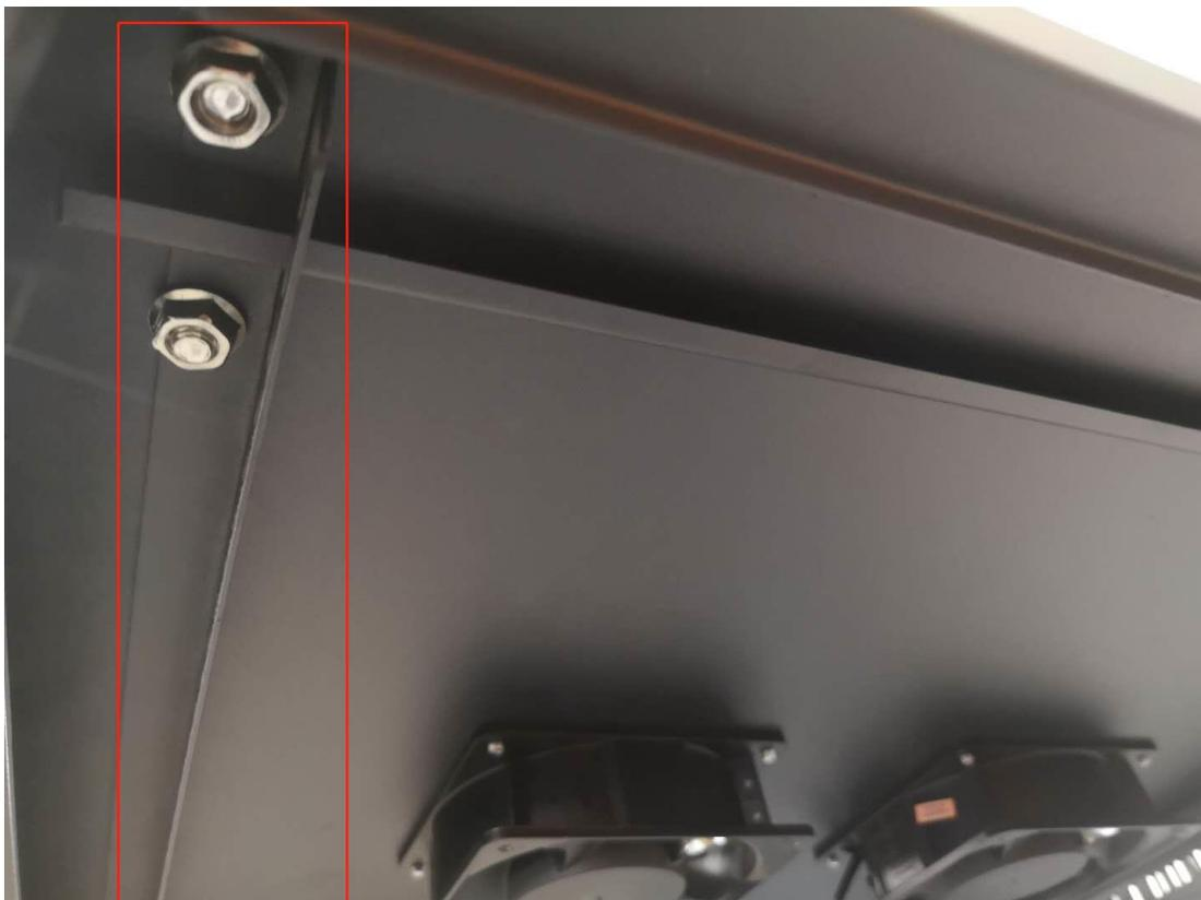
Colocamos los ángulos con la pestaña hacia el interior y atornillamos con los tornillos hexagonales. 4 tornillos por cada ángulo 8 para anclar el chasis, ángulo a la pieza superior.
