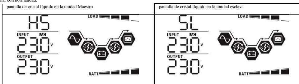
Paso 5: Si no hay más alarma de la avería, el sistema paralelo está completamente instalado.
