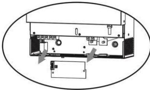
**Paso 3:** Retire los dos tornillos debajo de la carta como para sacar la cubierta de la comunicación en paralelo.
