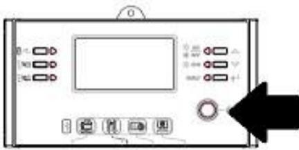
Paso 5. Asegúrese de seleccionar el tipo de batería como "PYL" en el programa del LCD 5.
