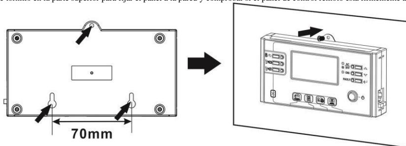
**Nota:** Instalación a la pared debe ser implementado con los tornillos adecuados. Consulte la tabla para especificación recomendada de tornillos.
