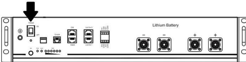
Paso 3. Pulse más de tres segundos para iniciar la batería de litio, la potencia de salida listo.
