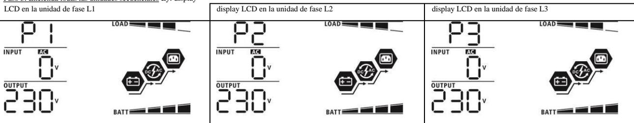
Paso 4: Encienda todos los interruptores de corriente alterna de hilos de línea en la entrada AC. Si se detecta la conexión de CA y tres fases se corresponden con ajuste de la unidad,
