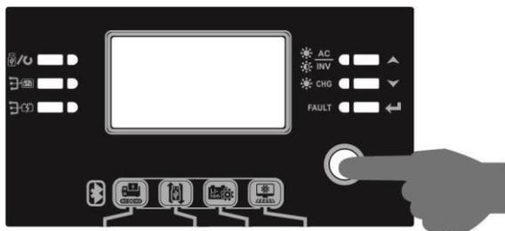
Una vez que la unidad se ha instalado correctamente y las baterías están conectadas así, sólo tiene que pulsar On / Off (que se encuentra en el botón de la caja) para encender la unidad.
