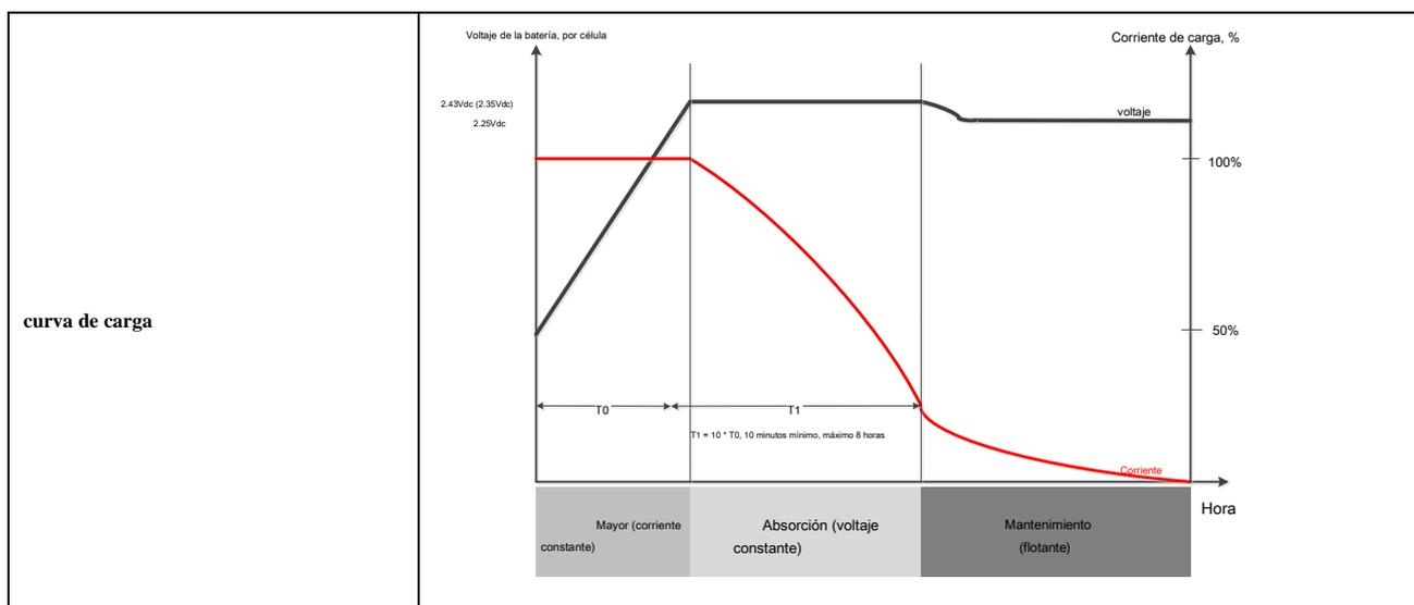
**Modo de carga solar (M PPT tipo)**
