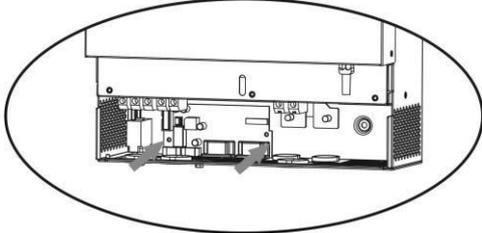
**Paso 5:** Vuelva a conectar 2-pin y 14-pin a la posición original, a bordo paralelo como se muestra debajo de la carta.
