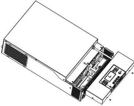
**Paso 2:** Retire los dos tornillos de la siguiente tabla y quite cables 2 pines y 14 pines. Sacar la tabla bajo el tablero de comunicación.
