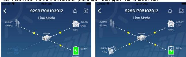
**[Battery Mode]** El **inversor** alimentará la carga desde la batería con o sin carga fotovoltaica. Sólo la fuente FV puede cargar la batería.
